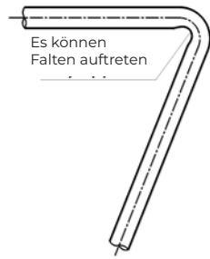
Bild 6.3 Biegen von Rohren über 90 °
